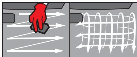
Для обработки составом больших участков кузова (капота, крыши, бампера) рекомендуем условно разделить их на 2 части и проводить обработку составом левой и правой частей поочередно, т.к. Акселератор очень летуч!
